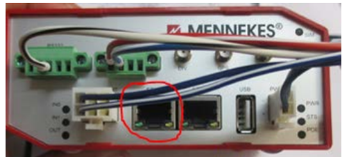
Abb. 2: Ethernet-Port "ETH0" an der ACU v4
